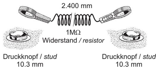
BJZ-Spiralkabel zeichnen sich durch ihre außergewöhnliche Elastizität und gutes Rückstellvermögen aus. Das geringe Gewicht sorgt für besten Tragekomfort. Die Kabel genügen höchsten technischen Anforderungen. Um Zugkräfte auf den Widerstand zu vermeiden, ist das Kabel im Übergangsbereich mehrfach zugentlastet.
